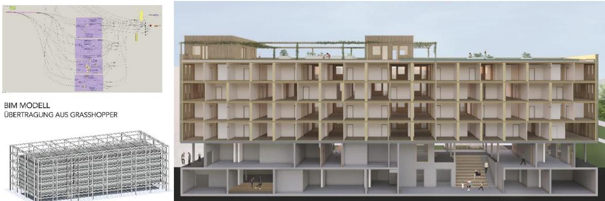
Abbildung 16: BIM Modell aus Grasshopper Algorithmus - Variante des Use Case - forschungsgeleitete Lehre, Projekt "BaumHome"
