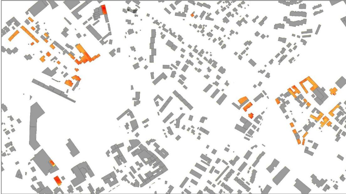
Abbildung 30: Karte der Critical Spots (anonymisierter Ausschnitt). Die farbigen Flächen indizieren Gebäude, die eine höhere thermische Emission aufweisen, als vergleichbare Gebäude.
