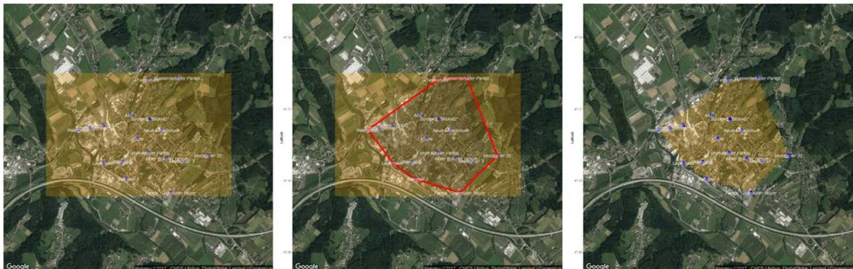
Abbildung 17: Messpunkte mit Punktegitter (links), Punktegitter mit konvexer Hülle (Mitte), konvexe Hülle (rechts)
