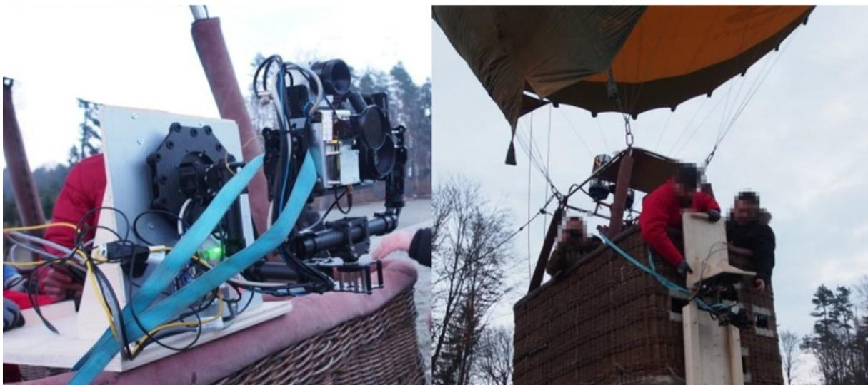
Abbildung 2: Kombiniertes Sensorkopf und Befestigung am Ballon
