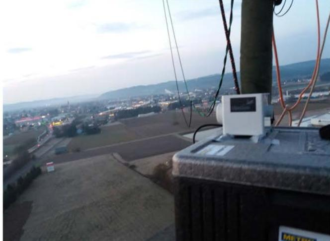
Abbildung 16: Messung mit dem Luftschadstoff-Messgerät am Heißluftballon
