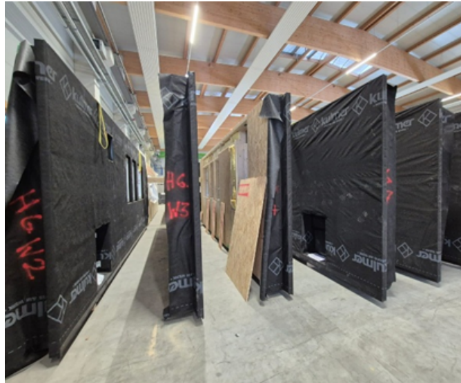
Abbildung 26. Serienproduktion der werksseitig produzierten Fertigteilfassaden.
