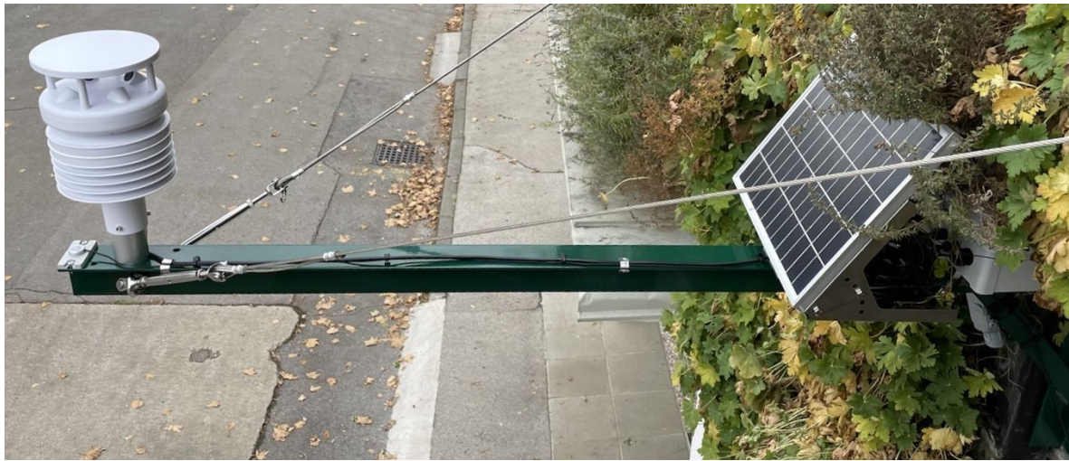
Abbildung 8: MS WTS305 [Wetterstation] und EKO ML-02-5P [Pyranometer], in 1,5m von Pflanzkörper entfernt (©IBLB).
