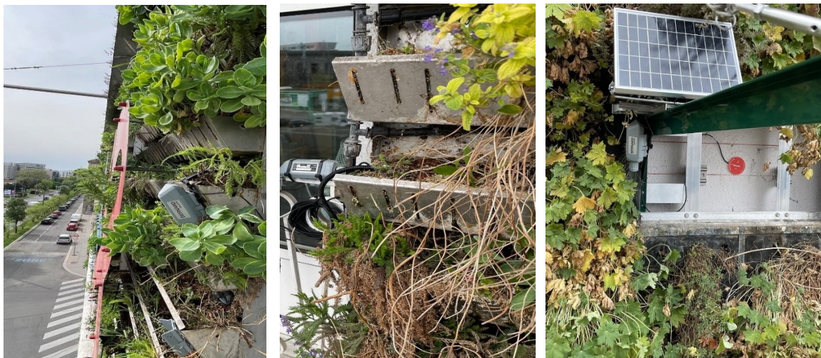
Abbildung 9: links: Luft-T und Luft-F-Sensor: SenseCAP S2101, Mitte: Boden-T und Boden-F-Sensor: SenseCAP S2104, rechts: Wärmedurchflusssensor Hukseflux HPF01 (©IBLB).
