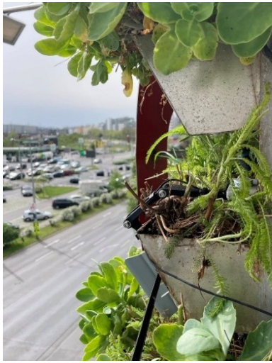
Abbildung 10: Sensorergänzung (2024): Pyranometer hinter dem Pflanzenkörper (©IBLB).
