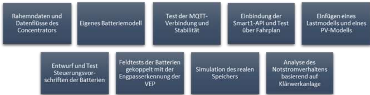
Abbildung 5: Stufenweise Entwicklung der Speicheransteuerung im Concentrator-In-The-Loop-Ansatz – von der Modellentwicklung über die Schnittstellenintegration bis zum gekoppelten Feldtest.
