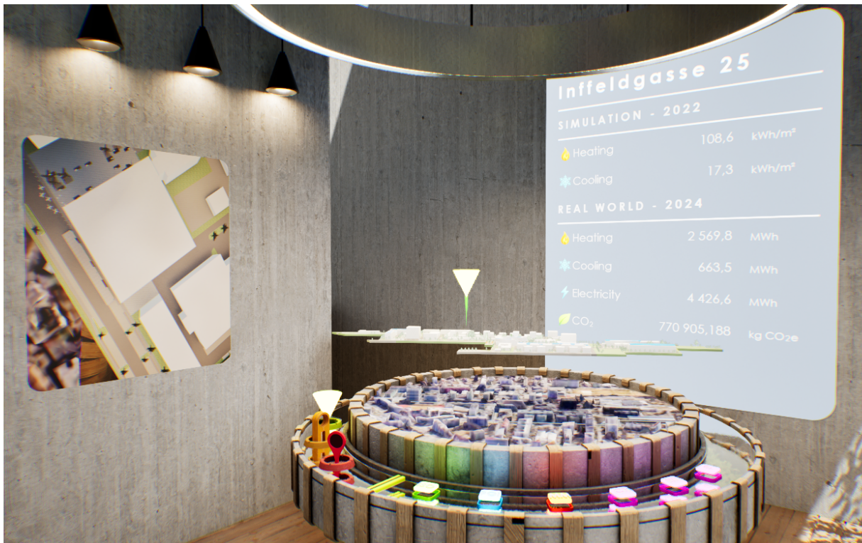
Abbildung 13. Mit dem Selektionstool wurde ein Gebäude am UIM-Modell markiert (Mitte), woraufhin Simulations- und IoT-Daten des entsprechenden Gebäudes (rechts) und das selektierte Gebäude von oben (links) gezeigt werden. Quelle: VR4UrbanDev
