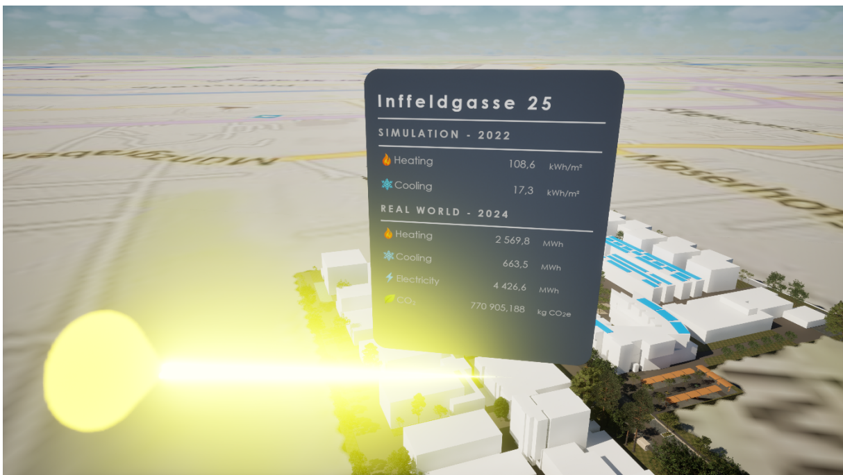
Abbildung 20: Auslesen und Anzeigen von Datenwerten einzelner Gebäude mit dem Selektionstool in der Überblicksperspektive. Quelle: VR4UrbanDev
