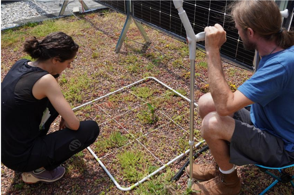
Abbildung 39 Durchführung der Vegetationsaufnahme von 2 Personen mit dem Frequenzrahmen. (Foto: Zluwa: GRÜNSTATTGRAU)
