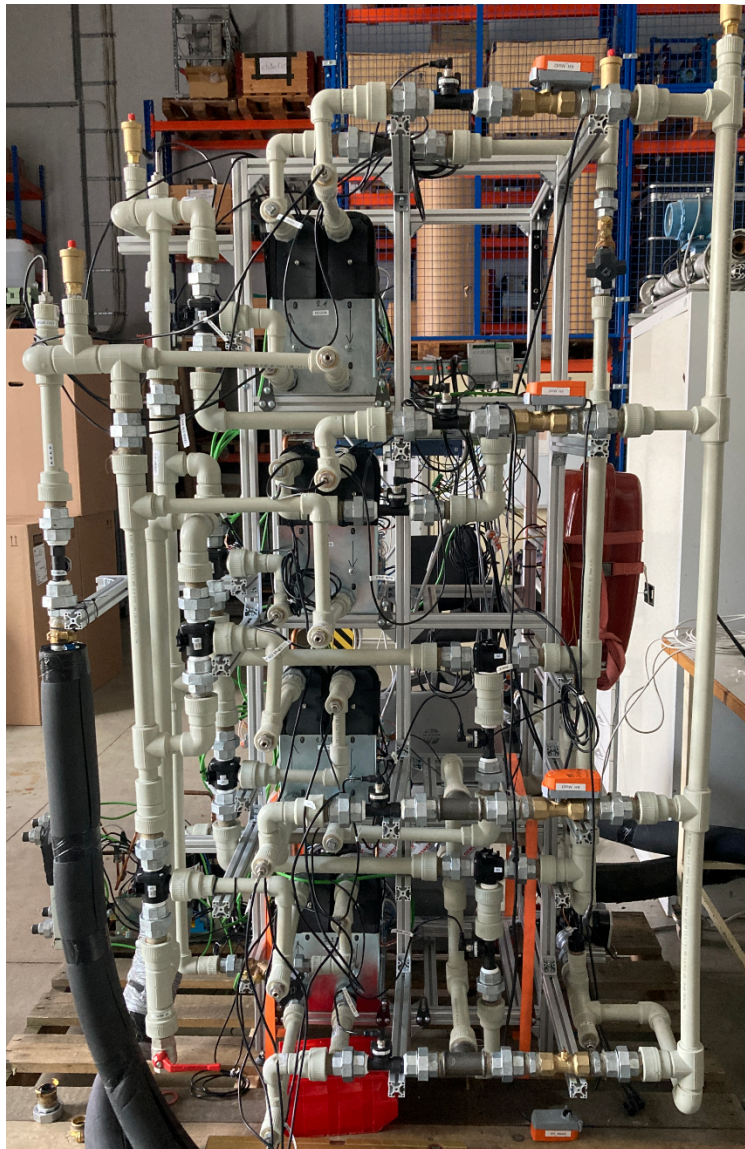
Abbildung 5: Aufbau des modularen Wärmepumpen-Racks mit Verrohrung aus Polypropylen Random Copolymer. Das Rack ist mit 4 Modulen bestückt, die in unterschiedlichen Konfigurationen verschalten werden können.
