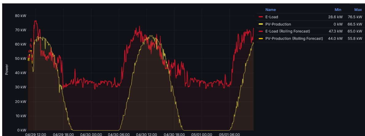
Abbildung 11: Grafana Dashboard der PV und Last Prognose des Microgrid Lab Controllers (Bildschirmausschnitt eines von BEST eingerichteten Grafana Dashboards)
