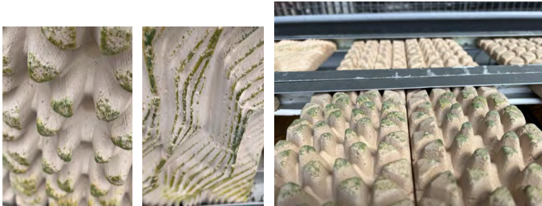
Abbildung 88: Moosbildung auf weißen Keramikplatten. – Quelle: Projektteam / Universität für angewandte Kunst Wien.
