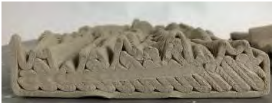
Abbildung 48: Ansicht der 3D-gedruckten keramischen Platte von unten. – Quelle: Projektteam / Universität für angewandte Kunst Wien.
