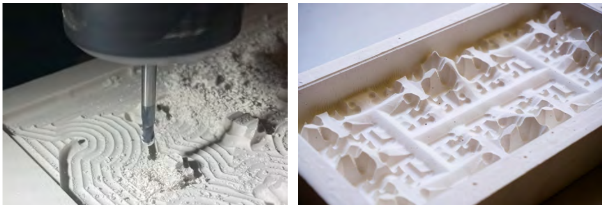
Abbildung 56: Detail des Fräasers und erste Fräsversuche. – Quelle: Projektteam / Universität für angewandte Kunst Wien.
