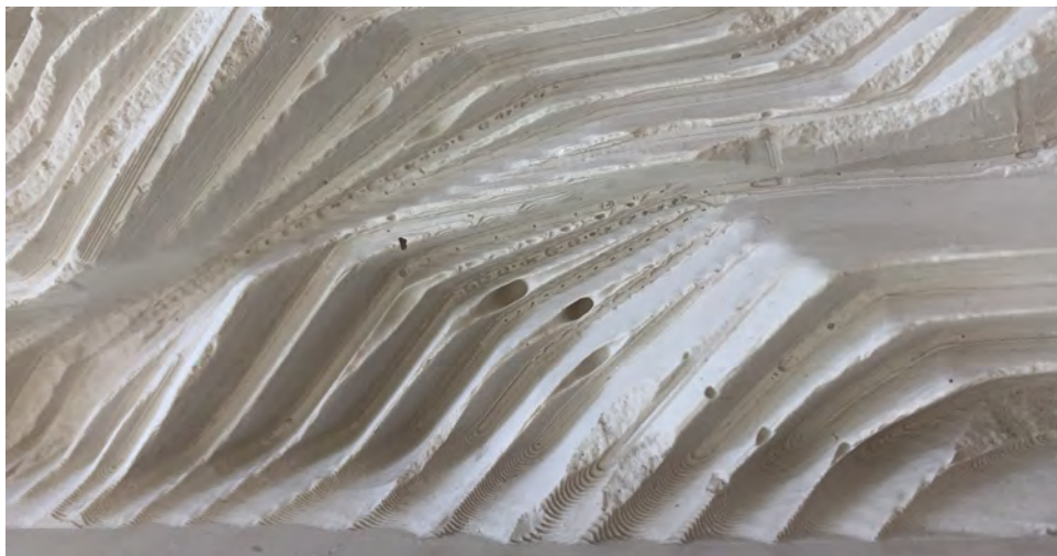
Abbildung 54: Luftblasen und ausgebrochene Details. – Quelle: Projektteam / Universität für angewandte Kunst Wien.
