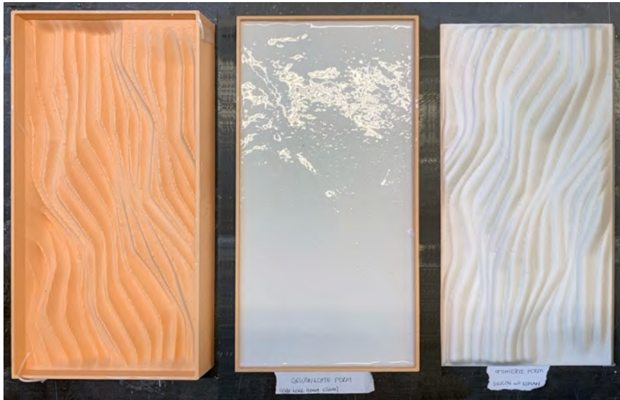
Abbildung 53: PLA-Negativform, Silikonguss und resultierendes Silikonformteil. – Quelle: Projektteam / Universität für angewandte Kunst Wien.
