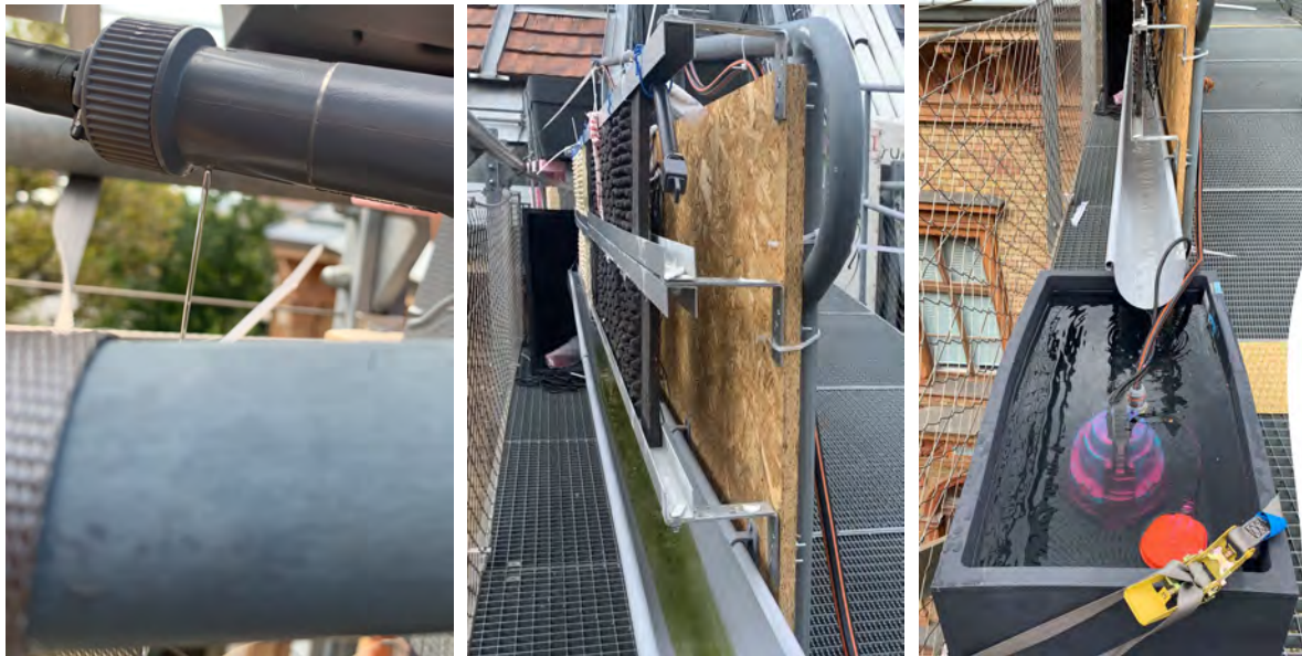
Abbildung 82: Wasserzufuhr mit Wassertank in der Seitenansicht der Versuchsanordnung. – Quelle: Projektteam / Universität für angewandte Kunst Wien.
