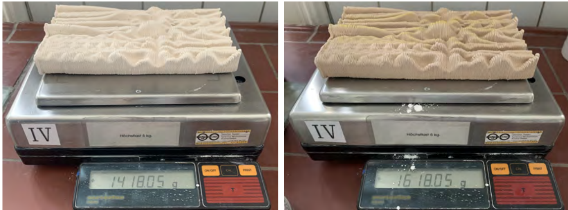
Abbildung 50: Wiegen der trockenen und getränkten Keramikplatte. – Quelle: Projektteam / Universität für angewandte Kunst Wien.
