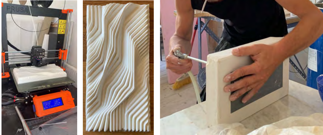
Abbildung 51: PLA-Formteil und Gipsabdruck. – Quelle: Projektteam / Universität für angewandte Kunst Wien.
