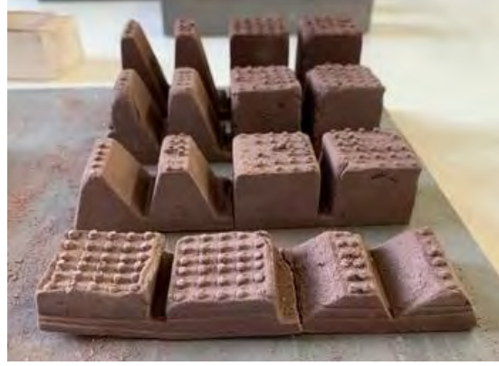
Abbildung 43: Digitales Modell von vier Formen mit unterschiedlichen Winkeln und Tiefen sowie das resultierende Pendant in Ton. – Quelle: Projektteam / Universität für angewandte Kunst Wien.
