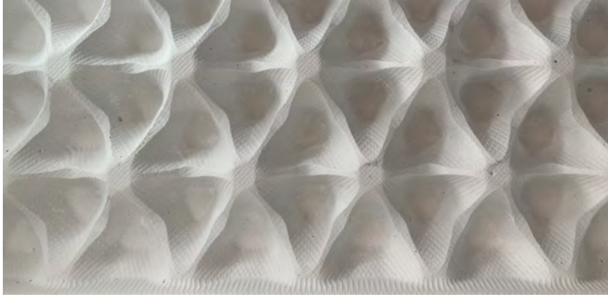
Abbildung 57: Frässpuren auf einer Gipsform mit korrekter Auflösung. – Quelle: Projektteam / Universität für angewandte Kunst Wien.
