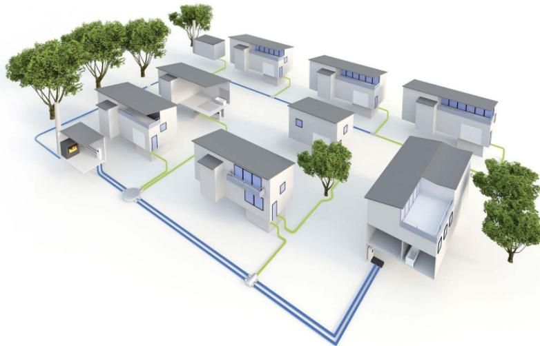
Abbildung 10: Nahwärmenetz (tab, 2023)
