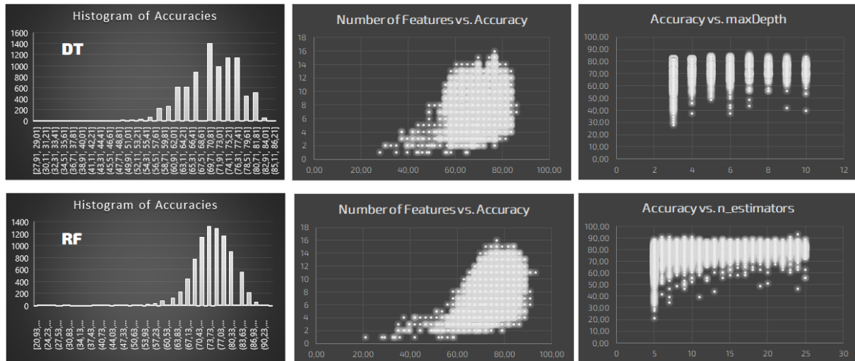
Abbildung 23: Genauigkeit von Decision Trees (obere Reihe) und Random Forests (untere Reihe). Spalten vlnr: Verteilung der Genauigkeiten, Anzahl der Features vs. Genauigkeit, Baumtiefe bzw. Anzahl der Trees im Forest vs. Genauigkeit (Screenshots).
