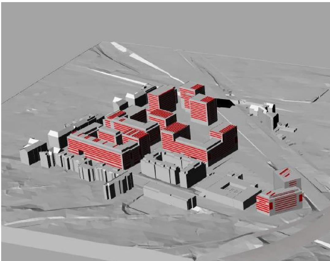
Abbildung 91: PV-Anlagenplanung für ursprünglichen Masterplan bestehend aus 50 % Dächern und gut belichteter Fassadenabdeckung.
