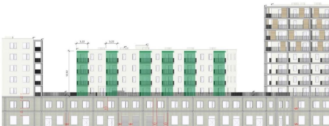
Abbildung 21: Variante C (Ansicht West BP1) mit bodengebundener, geschoßübergreifender Vertikalbegrünung mit Rankhilfen zwischen den Fenstern - brandschutztechnisch möglich, aber geringer Wirkungsgrad und geringe Gestaltungsqualität
