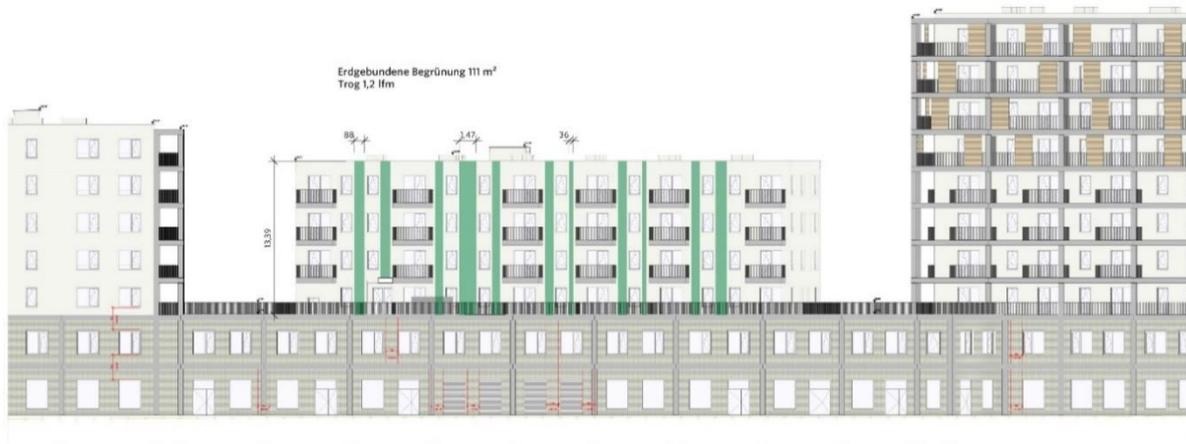
Abbildung 22: Variante D (Ansicht West BP1) mit wandgebundener Vertikalbegrünung und vollflächigem Vegetationsträger (Living Wall) zwischen den Balkonplatten
