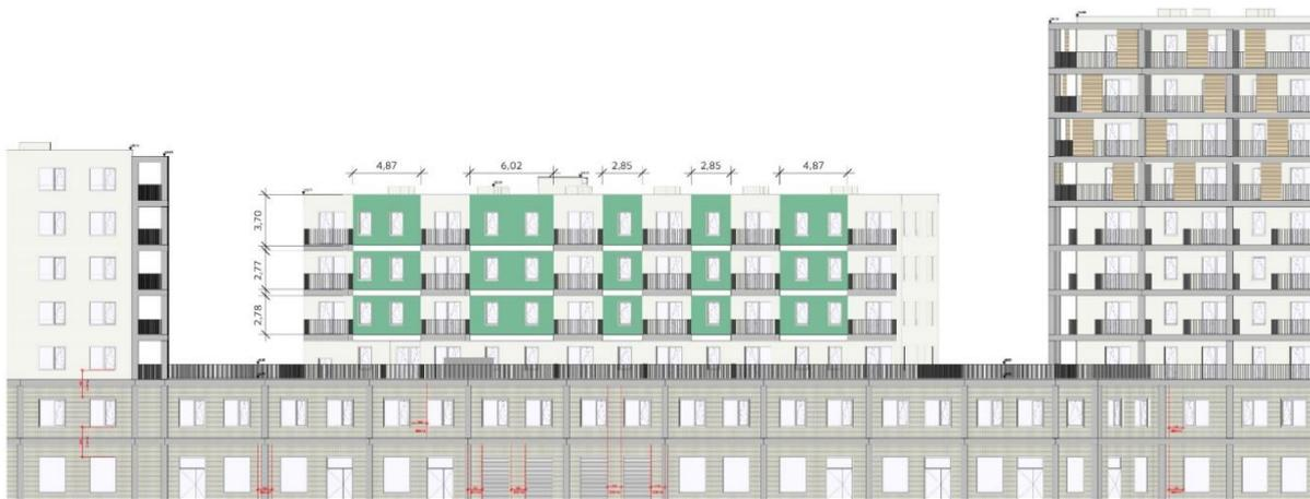
Abbildung 20: Variante B (Ansicht West BP1) mit bodengebundener Vertikalbegrünung und Rankhilfen VOR den Balkonplatten
