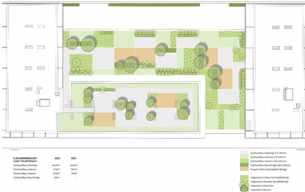
Abbildung 13: Verteilung von befestigten Flächen, intensiven und extensiven Grünflächen mit differenzierter Bepflanzung im Baufeld 2 in der optimierten Variante
