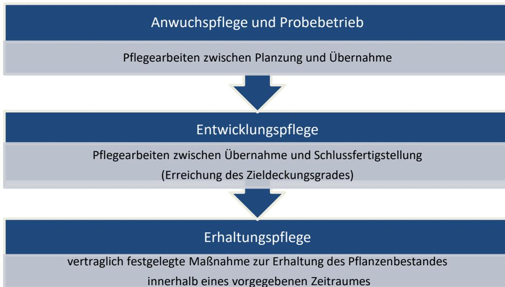
Abbildung 2: Erforderliche Pflegearbeiten in der Anwuchs-, Entwicklungs- und Erhaltungsphase von grünen Infrastrukturen (nach BMDW 2021). ©BOKU-IBLB, 2025.
