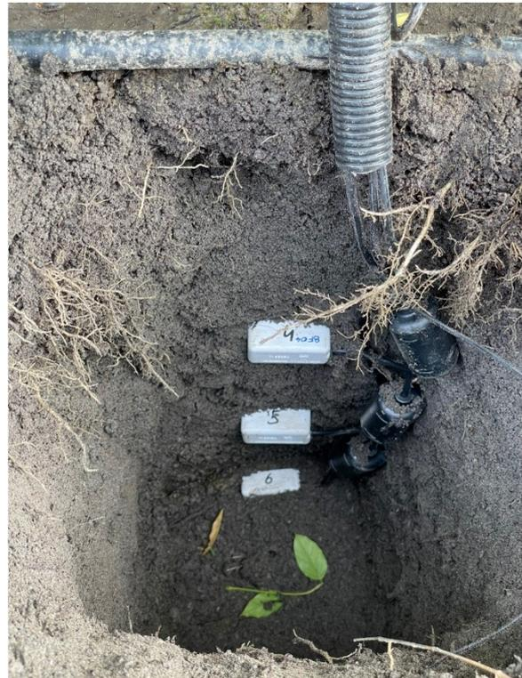
Abbildung 5: Einbau Bodenfeuchtesensoren (TEROS 11, Meter Group) am Standort SÖLL | TIROL 2022. ©BOKU-IBLB, 2025.
