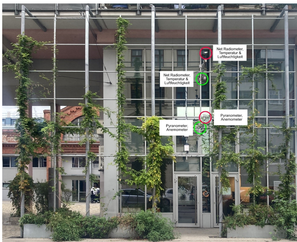
Abbildung 87: Sensorverortung am Standort KREUZGASSE | WIEN. Rot markiert sind Sensoren vor der Begrünung, in Grün, Sensoren hinter der Begrünung (Bild aufgenommen vor der Pflege im September 2024). ©BOKU-IBLB, 2025.
