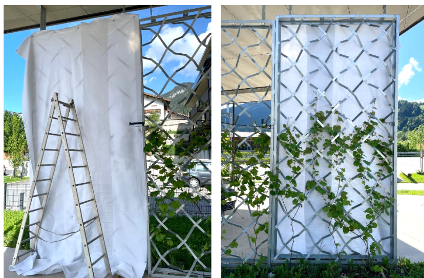
Abbildung 21: Zur Verbesserung des Kontrasts der Begrünung auf den Fotos wurde ein weißes Vlies an der Rückseite der Kletterhilfen befestigt, hier veranschaulicht an MP4 ( V. coignetiae ). ©BOKU-IBLB, 2025.
