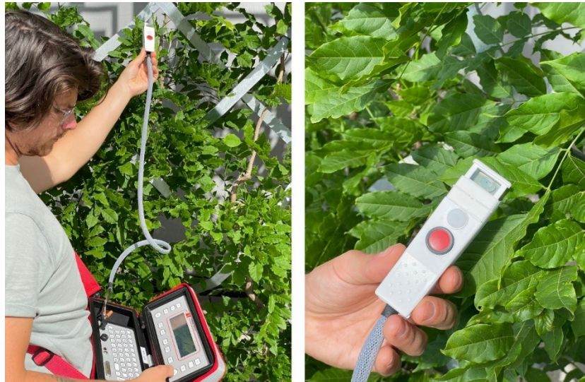
Abbildung 24: Messung der stomatären Leitfähigkeit ( stomatal conductance g_s ) an W. sinensis mit AP4 Porometer, Standort SÖLL | TIROL. ©BOKU-IBLB, 2025.
