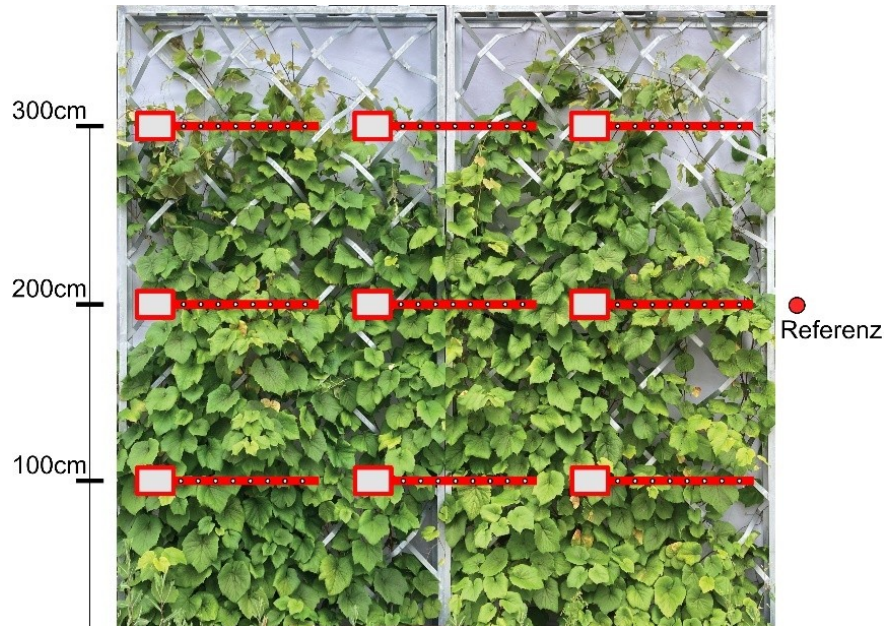
Abbildung 22: Schema der Messungen mit dem AccuPAR LP-80 je Messpunkt am Standort SÖLL | TIROL. Die Messung mit dem Ceptometer erfolgte an 9 Punkten hinter der Vegetation, der Referenzsensor wurde vor seitlich vor der Vegetation in 2m Höhe für alle Messungen gehalten (aus Poiss et al. 2025).
