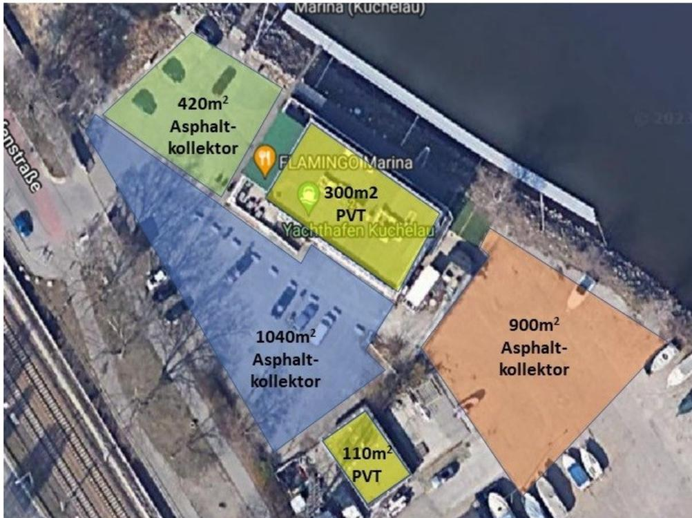
Abbildung 11: möglicher Platz für Asphaltkollektoren (Quelle: Google Maps, eigene Bearbeitung)
