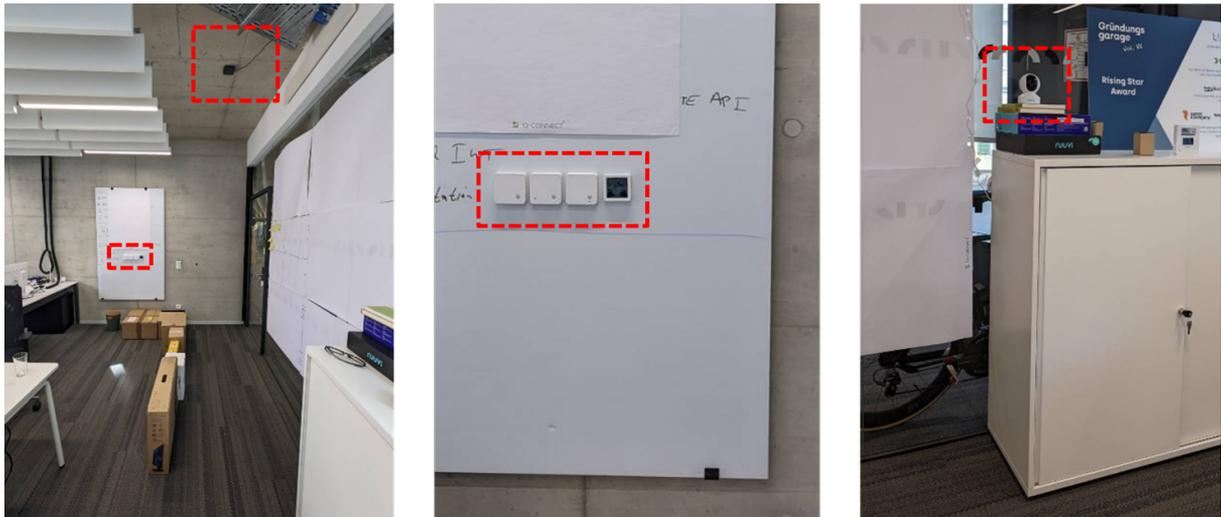
Abbildung 6: Raum A (DiLT Büro) mit diverser Sensorik - 3 unterschiedliche Elsys-Sensoren (Mitte), People Counter System (Links) und Kamera (rechts) zur Personenzählung
