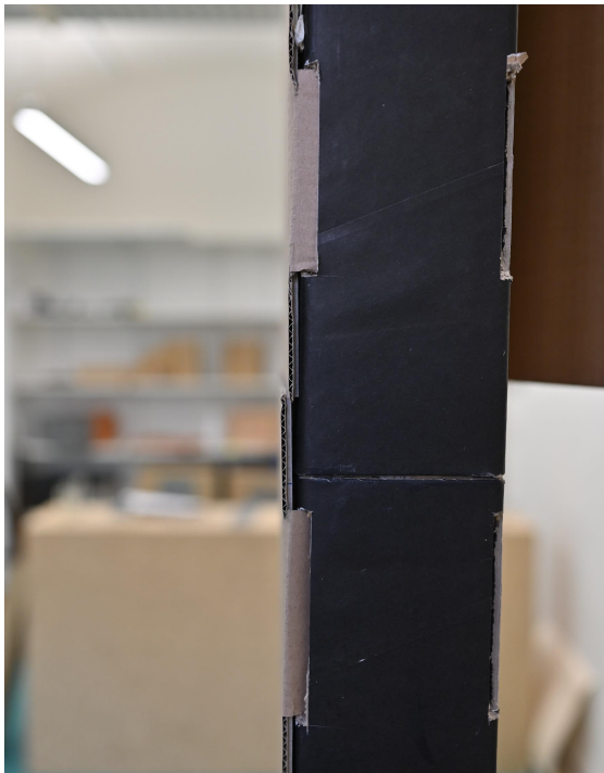
Abbildung 59: Modell Innenausbausystem, Kombination der Beplankung aus Wellpappe mit Graupappe [Institut für Architekturtechnologie (IAT), TU Graz]
