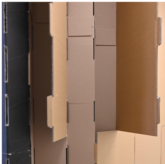
Abbildung 57: Modell Innenausbausystem, Befestigung der Beplankung an der falt-Unterkonstruktion und der Wickelhülse [Institut für Architekturtechnologie (IAT), TU Graz]
