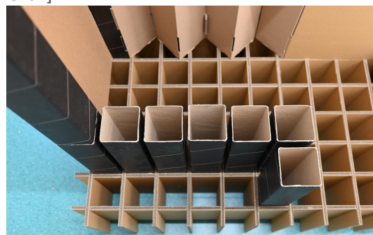
Abbildung 62: Modell Innenausbausystem, Erhöhung der Anzahl der Wickelhülsen [Institut für Architekturtechnologie (IAT), TU Graz]
