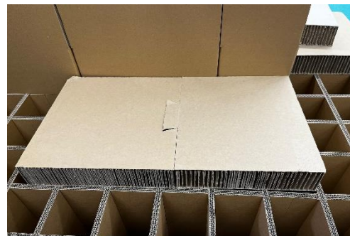
Abbildung 54: Modell Innenausbausystem, Fußbodensystem, Seite 2 [Institut für Architekturtechnologie (IAT), TU Graz]
