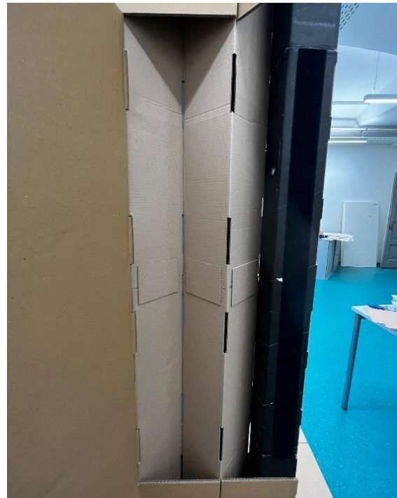
Abbildung 60: Modell Innenausbausystem, Befestigung der Beplankung mittels Klettverbindung [Institut für Architekturtechnologie (IAT), TU Graz]
