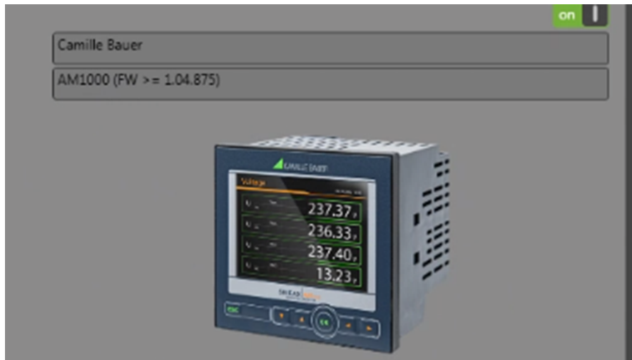
Abbildung 3: Messgeräte in den Trafostationen der Stadtwerke Hartberg
