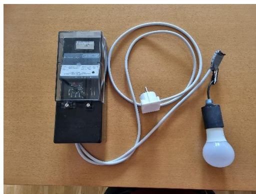
Abbildung 7: Rundsteueranlage und Signallampe für den Demonstrationsbetrieb
