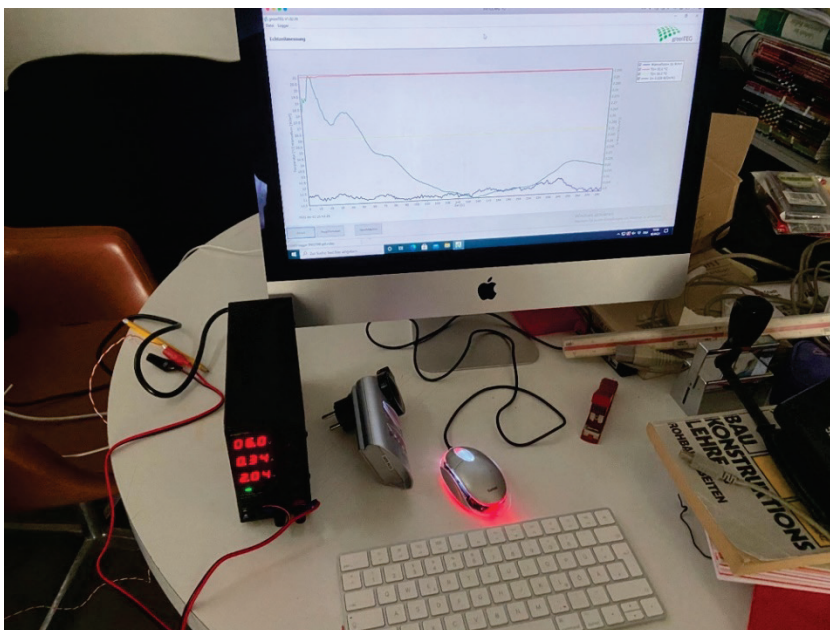
Abbildung 46: Mess-Software und Netzgerät zur Simulation der Heizstäbe
