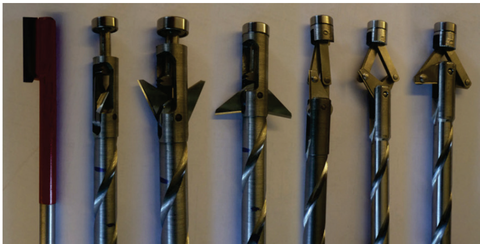
Abbildung 28: Bohrer für das Aufweiten im Inneren einer Bohrung xviii
