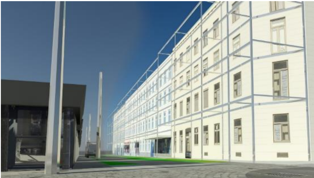
Abbildung 29: Schematische Darstellung der skalierbaren, freistehenden Tragstruktur (© EIGENSINN)
