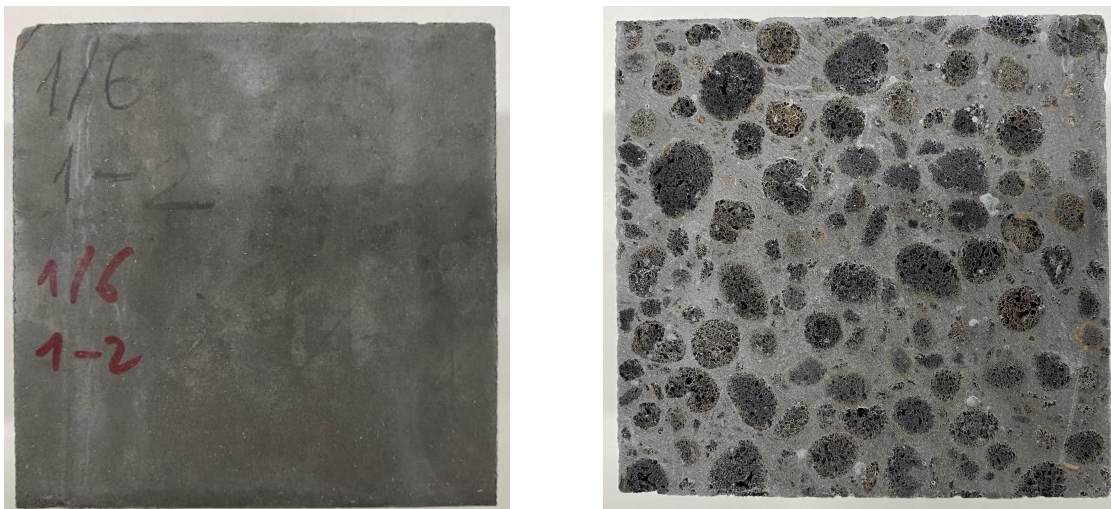
Abbildung 13: Geschnittene Betonproben zur Bestimmung der Wärmeleitfähigkeit, geschlossene Oberfläche (links), offenporige Oberfläche (rechts)
