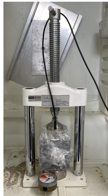
Abbildung 6: HLQ-Sonde im Zuge der Versuche, Sonde auf einem Kalibrierstück (links), Versuchsaufbau in einem Kühlschrank (rechts)
