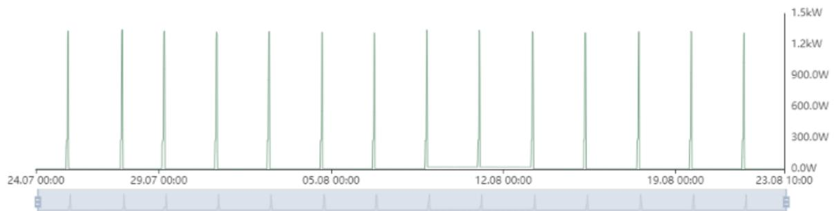
Bei Top 2.6 zeigt sich eine geringe Betriebsdauer mit der Wärmepumpe allein, der E-Heizstab ist häufig der alleinige Warmwasserbereiter bzw. muss zusätzlich zur Wärmepumpe in Betrieb gehen.
