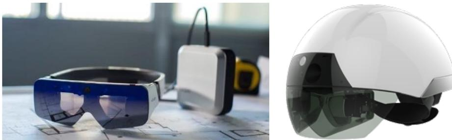
Neben diesen genannten Produkten gab es außer der Microsoft HoloLens 1 (Microsoft, 2019) kein anderes vergleichbares Gerät, das die Anforderungen im industriellen Umfeld erfüllt. Bei der HoloLens 1 und Meta 2 ist jedoch das Tragen eines Sicherheitshelms nicht möglich und daher sind diese für den Einsatz auf der Baustelle nicht geeignet.
