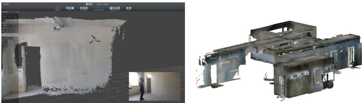
Die Ergebnisse bestätigten die früheren, unter Laborbedingungen erhalten Erkenntnisse, dass sich die Qualität des Scans bei Entfernungen über 3 m schnell verschlechterte, aber bei kürzeren Entfernungen eine ausreichende Qualität zum Scannen und Identifizieren aller kritischen Eigenschaften bietet.
