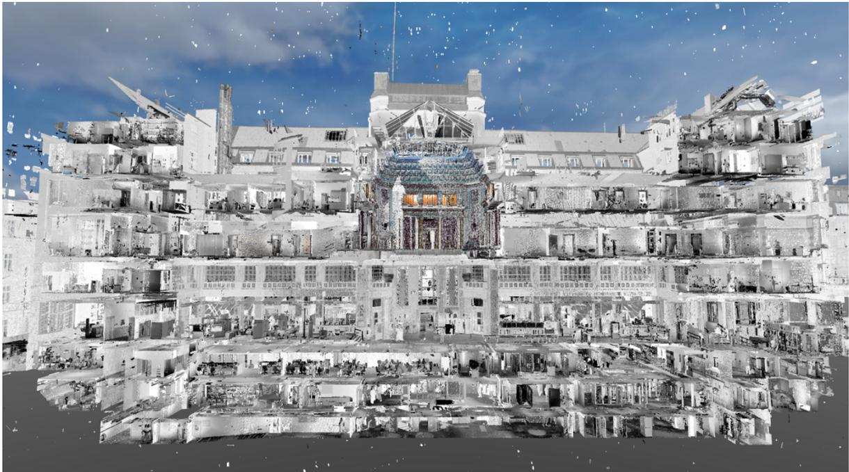
Abbildung 74: 3D Bestandsvermessung mittels terrestrischem Laserscanner eines 30.000m<sup>2</sup> großen denkmalgeschützten Gebäudes in Wien, © Meixner Vermessung ZT GmbH
