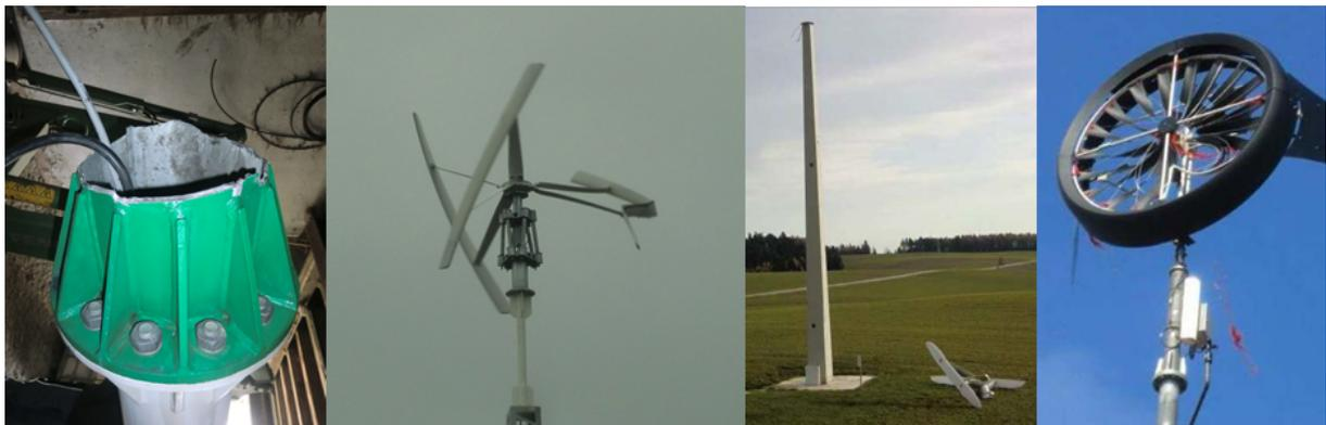
Abbildung 10: Erfahrungen aus dem Energieforschungspark Lichtenegg: gebrochener Stahlmast einer KWEA (links), gebrochener Flügel einer KWEA (Mitte links), abgestürzter Rotor (Mitte rechts), defekte KWEA Typ Windtronics (rechts)
