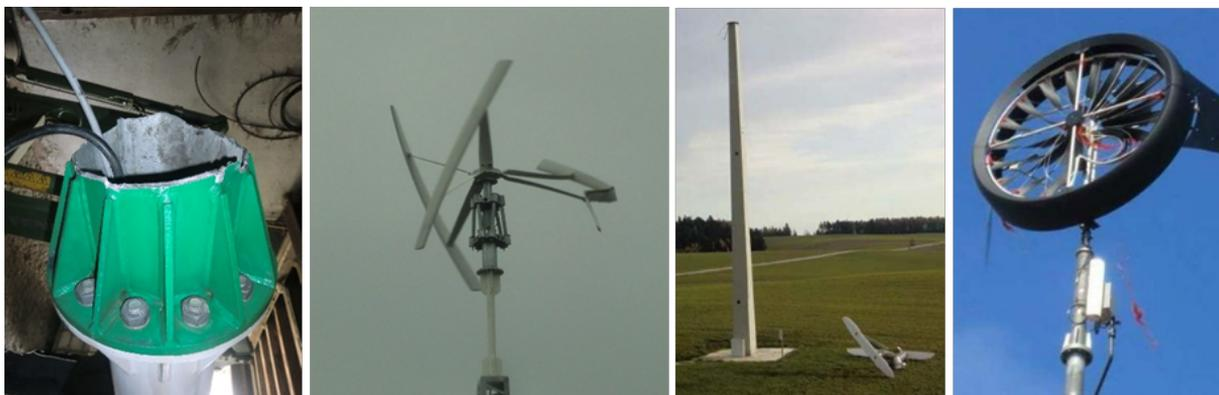
Abbildung 102: Erfahrungen aus dem Energieforschungspark Lichtenegg: gebrochener Stahlmast einer KWEA (links), gebrochener Flügel einer KWEA (Mitte links), abgestürzter Rotor (Mitte rechts), defekte KWEA Typ Windtronics (rechts)
