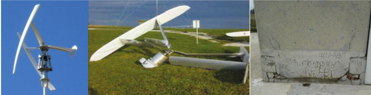
Abbildung 103: Schäden durch Vibrationen und Schwingungen
