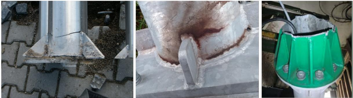
Abbildung 107: Risse an Schweißnähten aufgrund von Resonanzschwingungen
