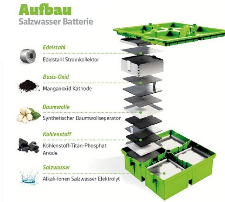
Abbildung 5: Aufbau eines Moduls der Natrium-Ionen Batterie, Typ 48S-2.2 (BlueSky Energy 2, 2019)
