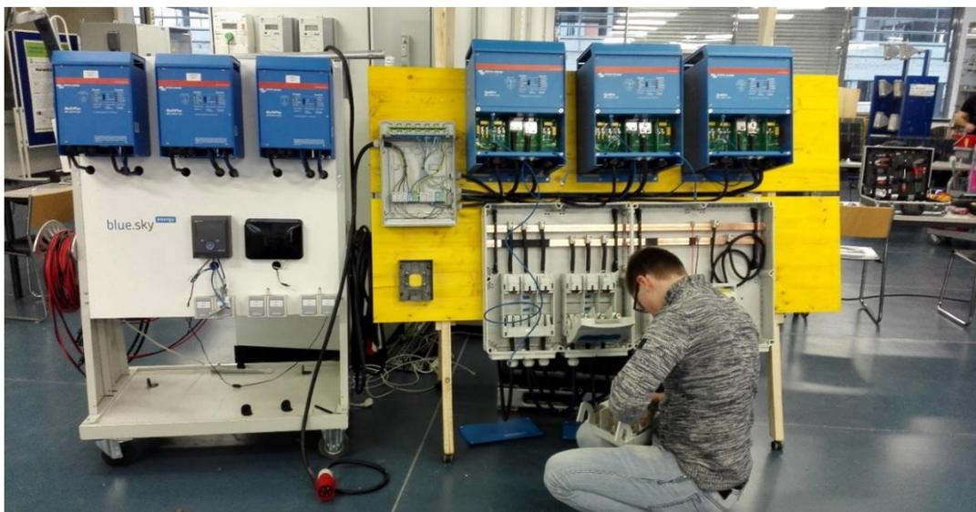
Abbildung 17: Aufbau der Wechselrichter und der DC-seitigen Schutzeinrichtung
