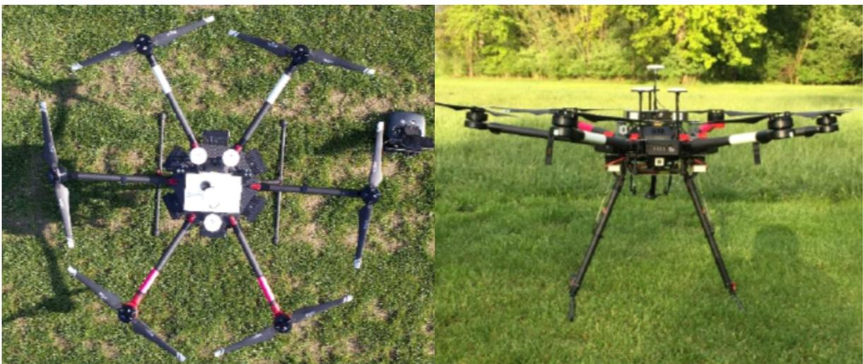
*Abbildung 5: DJI M600pro (modifiziert) in Draufsicht (linkes Bild) und Seitenansicht (rechtes Bild) (Lederbauer, 2019)*
