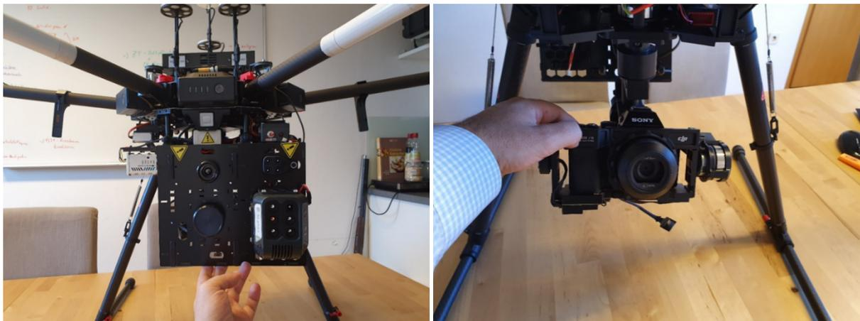
Abbildung 6: Klappbare Halterung für multispektrale bzw. thermale Sensorik an DJI M600pro (linkes Bild); Sony A7r auf DJI Zenmuse (rechtes Bild) (Lederbauer 2019)
