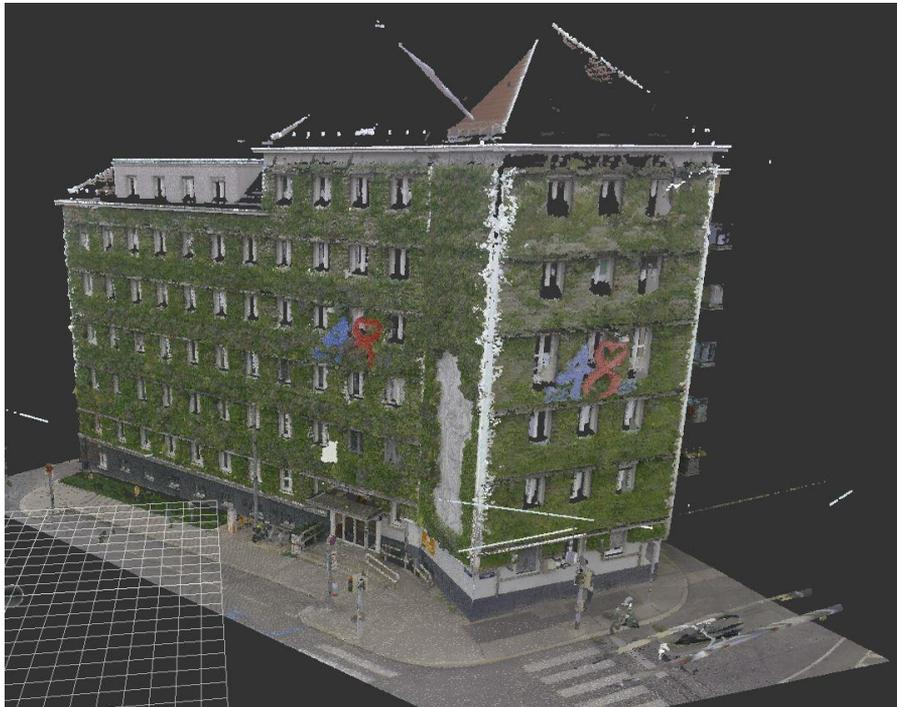
Abbildung 24: Mittels terrestrischem Laserscanner erfasste Punktwolke (Grünfassade MA 48, Wien)
