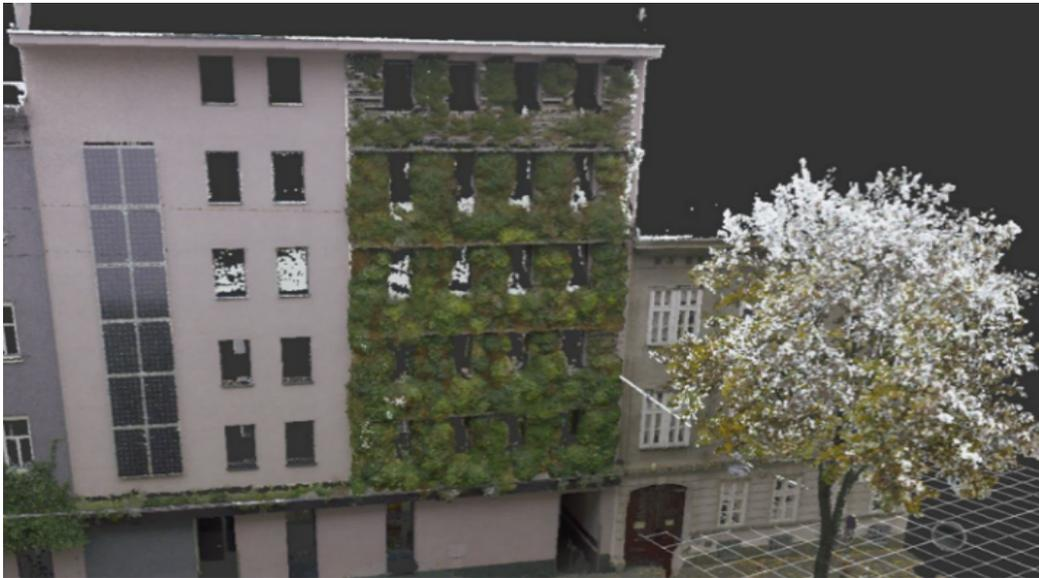
Abbildung 26: Unbearbeitete Punktwolke der Grünfassade (Hackengasse 18, 1150 Wien)
