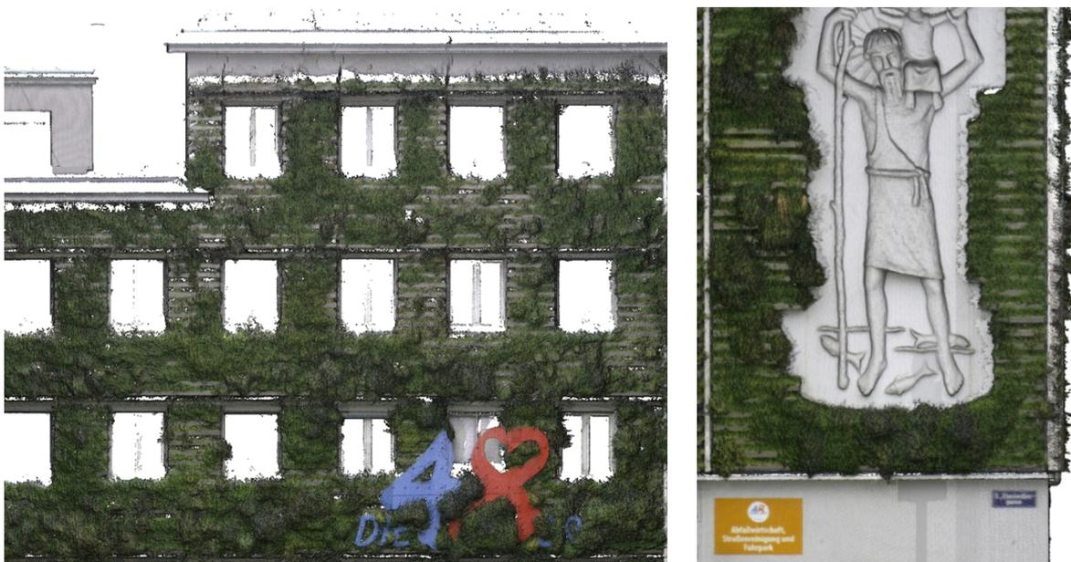
Abbildung 25: Aus der Punktwolke und Farbinformation abgeleitete Orthofotos (MA 48 Zentrale, Detail)
