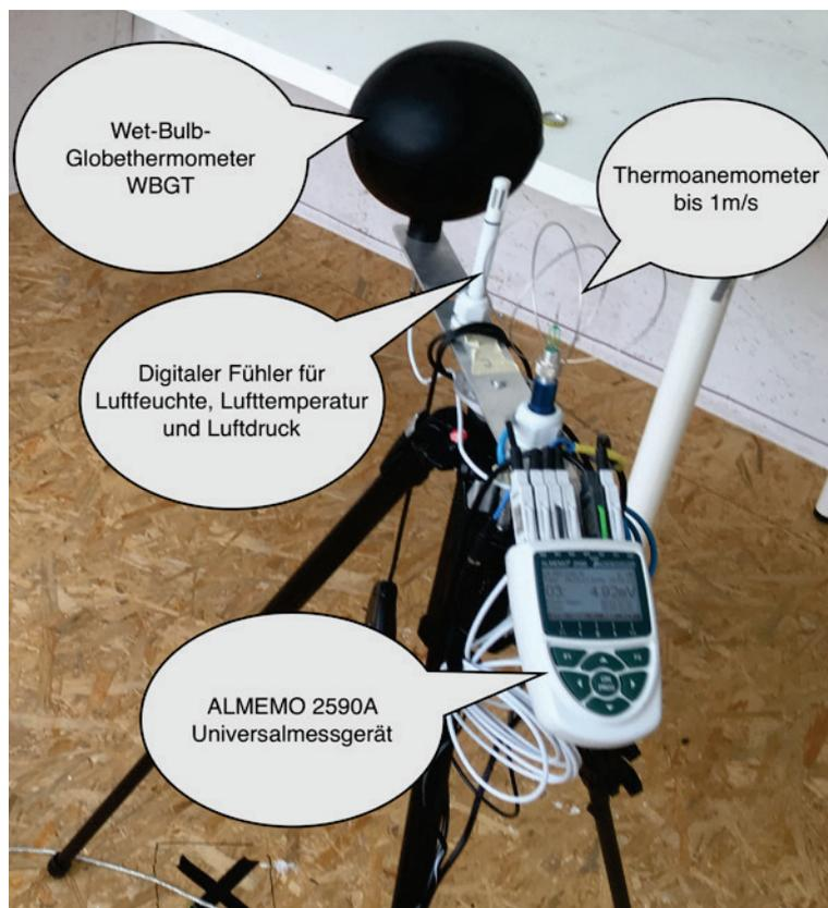
Abbildung 21: Thermal Comfort Station der Fa. Ahlborn
