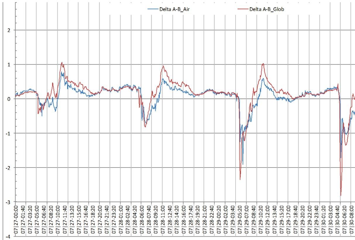
Abbildung 26: Temperaturdifferenz [K] zwischen Raum A und Raum B (A-B), 27.-30.7.2018
