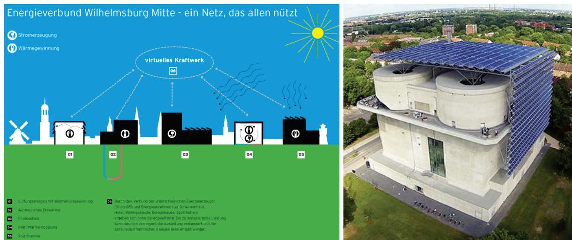
Abbildung 125: (Links) Funktionsschema »Energieverbund Wilhelmsburg Mitte«, Quelle: IBA (2014); (Rechts) Der Energiebunker, Quelle: Hamburg Energie<sup>110</sup>
