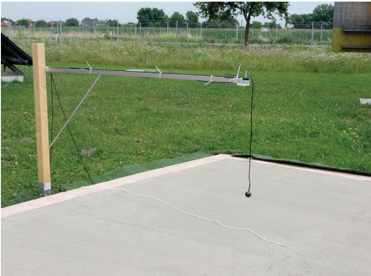
Abbildung 14: Anordnung der Messsensoren über der Versuchsfläche
