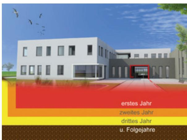
Abbildung 68: schematische Darstellung der Erweiterung eines ca. 5.000 m<sup>3</sup> Erdspeichers (Flachspeicher) unter einer Bodenplatte eines Betriebsgebäudes nach Inbetriebnahme<sup>55</sup>
