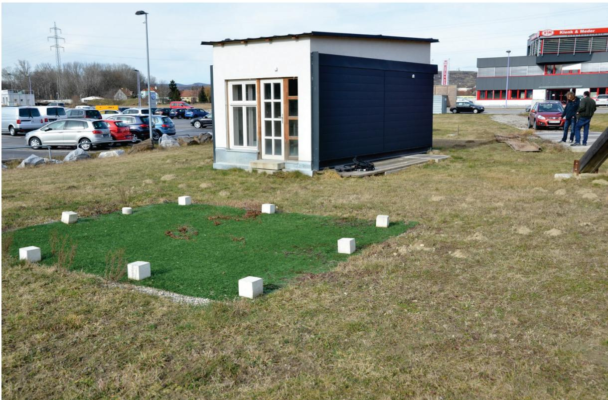
Abbildung 2: Versuchsgelände HTL Krenns (vorne: Kunstrasenfläche, hinten: Versuchskubus mit Pufferspeicher, Wärmepumpe, E-Verteilung und EDV-Ausstattung)
