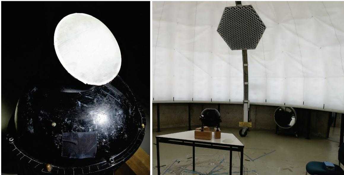
Abbildung 34: Messung des SonnenNutzKopfs mit SonnenSchlumpf im künstlichen Himmel
