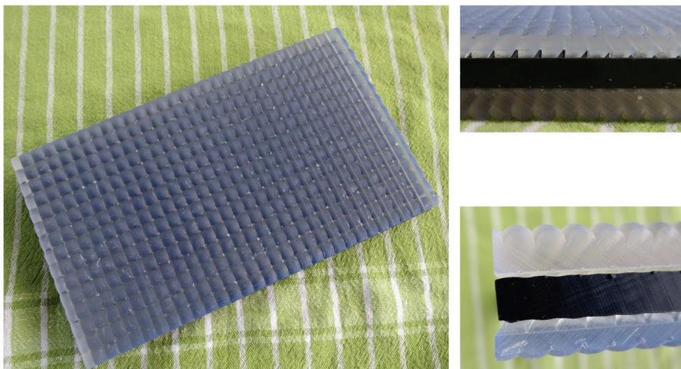
Abbildung 27: Linsenplatte, Freiformflächen-Näpfchenlinse (3D-Druck, Designmuster ohne lichttechnische Funktion)
