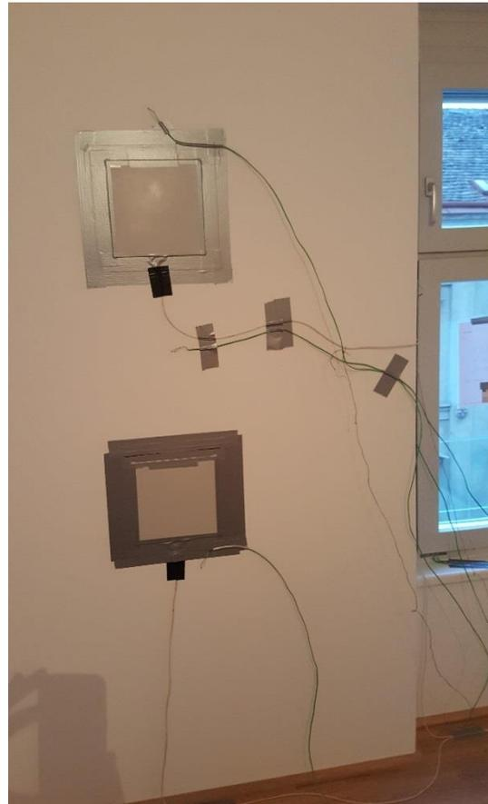
Abbildung 5 Aufbau der Messung der fertig sanierten Fassade, Quelle e7
