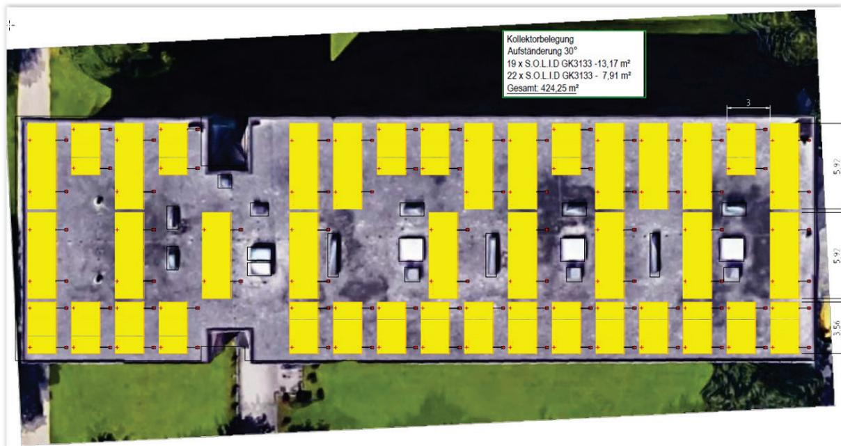
Abbildung 20 Flachdach des Wohngebäudes Goethestraße 15, mit exemplarischer Solarkollektorbelegung (gelb), wobei gesetzliche Mindestabstände zu Dachaufbauten und notwendige Servicewege sind berücksichtigt.
