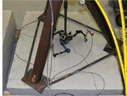
(b) Spalten eines Probekörpers aufgrund zu geringer Bauteildicke (Sigl, 2016)
