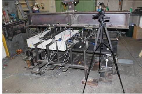
(b) Versuch am Gesamtsystem – das Gesamtsystem Anschlussdecke und Balkon sind als Betonprüfkörper abgebildet
