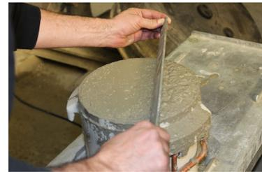
(f) Füllen Behälter Ermittlung Luftbohrengehalt
