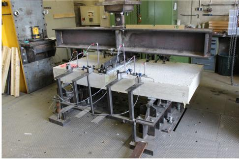
(a) Versuch am Teilsystem – nur der Bereich Anschlussdecke ist als Betonprüfkörper abgebildet
