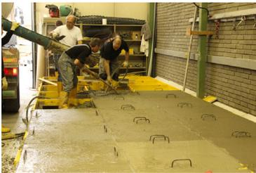
(d) Betonage der Prüfkörper für Einzelversuche
