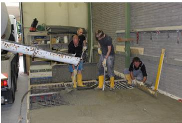
(g) Betonage der Prüfkörper für Bauteilversuche
