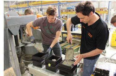
(c) Herstellung der Betonprüfwürfel
