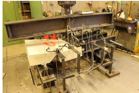
(d) BV41 mit Einbindetiefe  $h = 500$  mm
