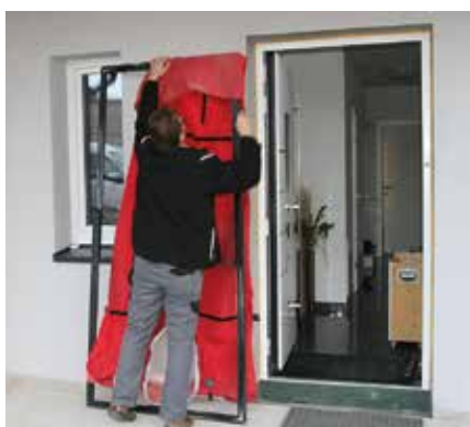
Abb. 10 | Messgerätschaft für den Blower-Door-Test. © vöz
