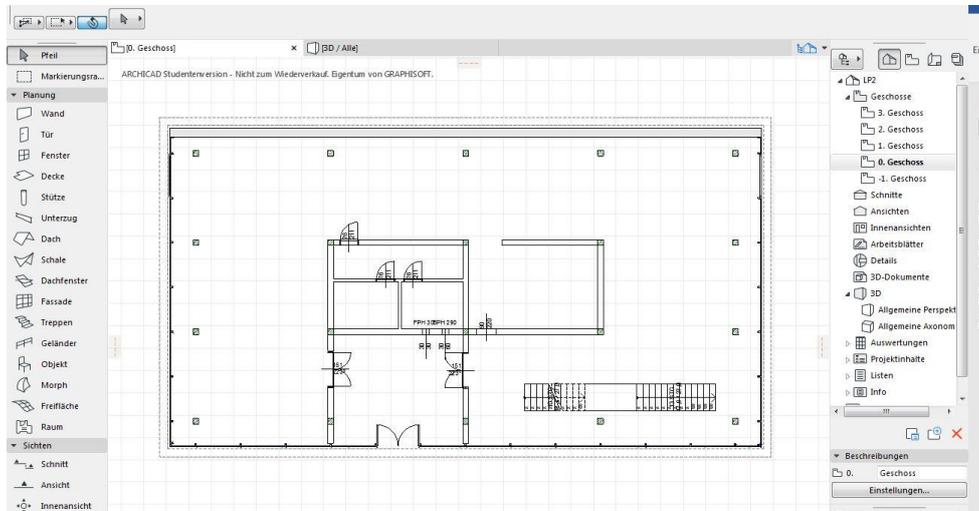
2. **Layerstruktur** des Templates verwenden. Alle mit XX vorangestellten Layer können verwendet werden (Bsp: XX\_Innenwände), außer den Layern aus dem Bauteilkatalog (XX\_Bauteilkatalog...).
