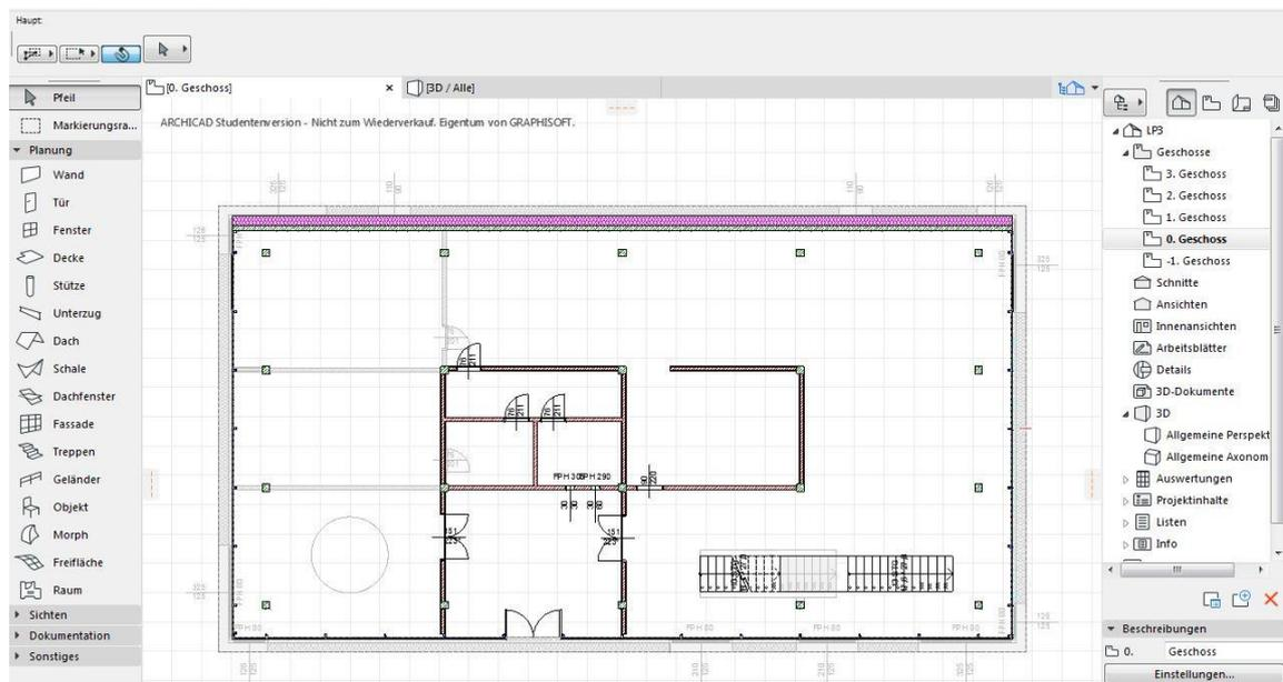
2. Bei **Türen, Fenstern, Fassaden** und **Oberlichtern** muss der Rahmen und das Glas bzw. Paneel-Material definiert werden. Hierfür z.B. beim Fenster Glasmaterial „XX\_Dreifachwärmeschutzglas“ auswählen; ebenso bei den Rahmen und anderen Elementen.
