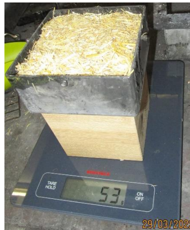
Abbildung 1: Strohprüfmuster in der Probehaltung des Cone-Calorimeter
