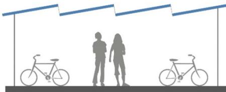
Abbildung 13: Anwendungstyp PV-Überdachung, zum Beispiel für (Park-) Plätze (AIT/PVS 2016)
