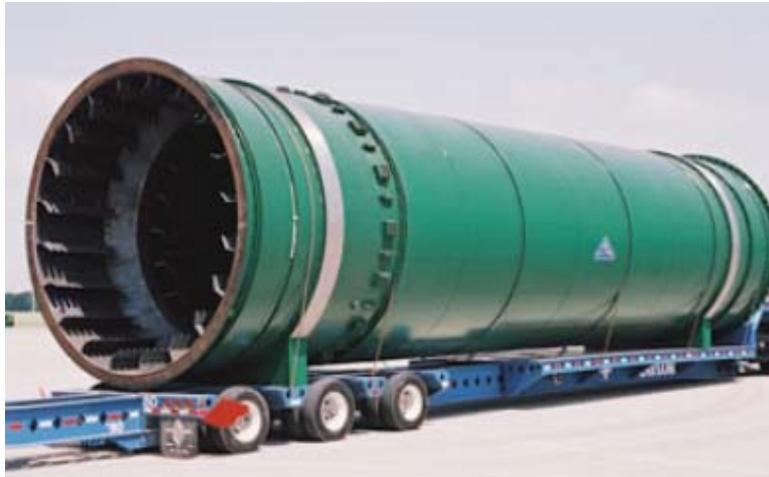
Abbildung 27: Industrieller Drehrohrofen, welcher zur Trocknung von Sorptionsmaterialien verwendet werden kann (M-E-C Design and Engineering 2017)
