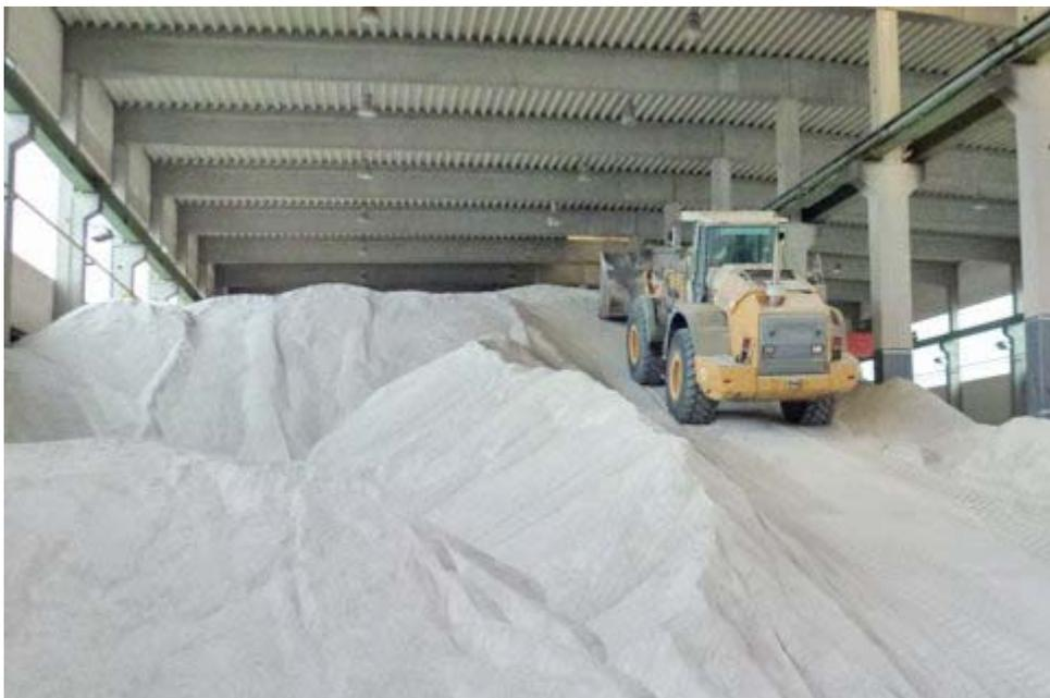
Abbildung 29: Salzlagerung in Hallen. Durch geeignete Feuchtigkeitskonditionierung ist eine Lagerung von getrockneten Sorptionsmaterialien vom Sommer in den Winter möglich (Wilhelm Geiger GmbH & Co. KG 2017)
