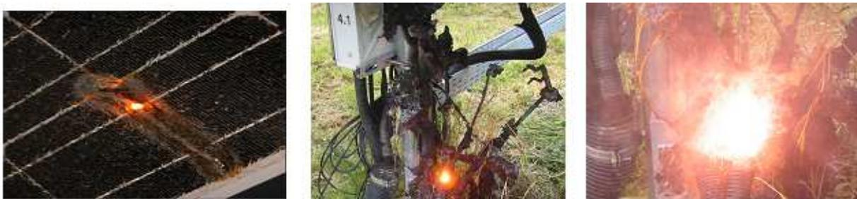
Abbildung 1: Beispiele zu real auftretenden Lichtbögen (links: Aufschmelzen einer schadhafte Kontaktstelle direkt im PV Modul, mitte und rechts: Brand am Stranganschlußkasten) (Vaaßen, 2007)
