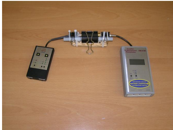
Abbildung 3: Aufbau CO2-Sensor mit IR-LED und Photodiode mit galvanisch vergoldetes Rohr als Strahlengang
