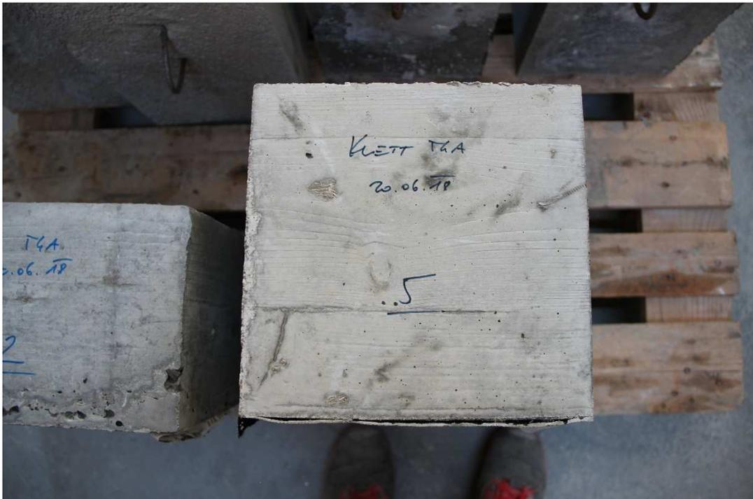
Abbildung 4.18 Versuchskörper 5 - Flauschmatte verklebt mit Klettband
