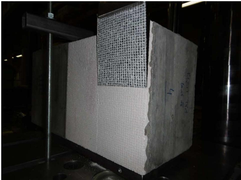
Abbildung 4.54 Abschälen des Gittergewebes mit Velours von der Trägerplatte
