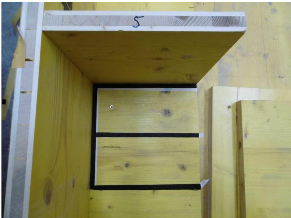
Abbildung 4.5 Versuchskörper 5, Einkleben der Klettstreifen mit doppelseitigem Klebeband
