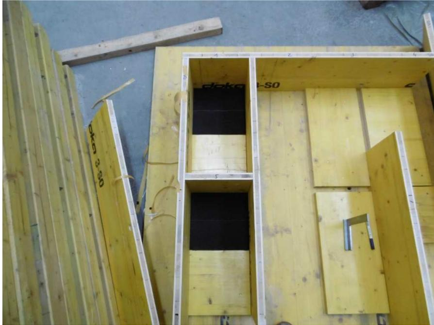
Abbildung 4.6 Versuchskörper 1 + 5, Flauschmatte eingeklebt bzw. geklettet
