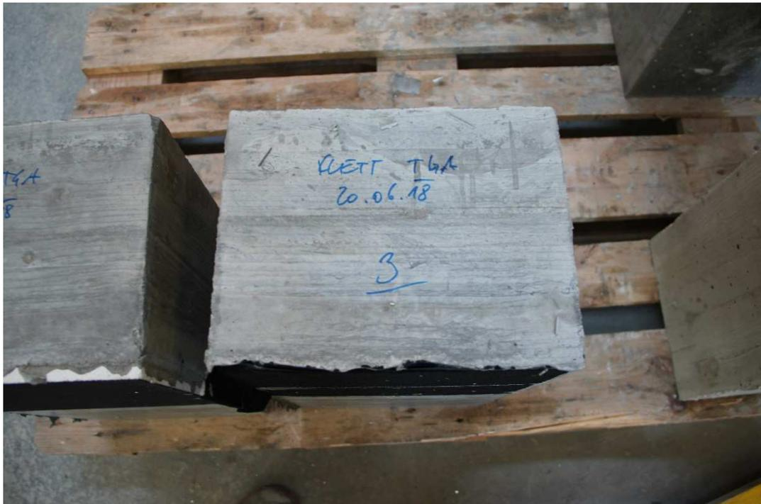
Abbildung 4.14 Versuchskörper 3 - Doppelflausch kreuzweise verklebt
