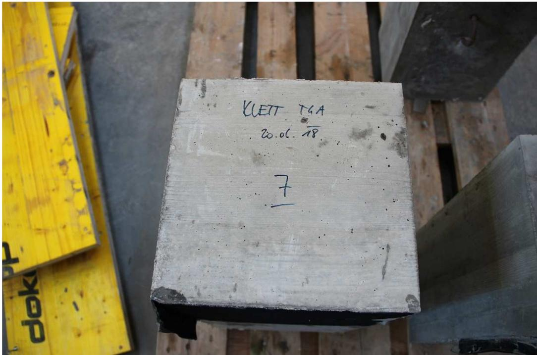
Abbildung 4.22 Versuchskörper 7 - Doppelvelours
