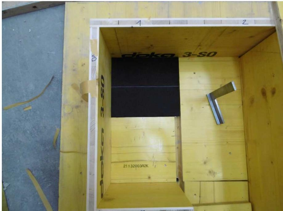
Abbildung 4.4 Versuchskörper 1, Einkleben der Flausmatte (2 Streifen nebeneinander)
