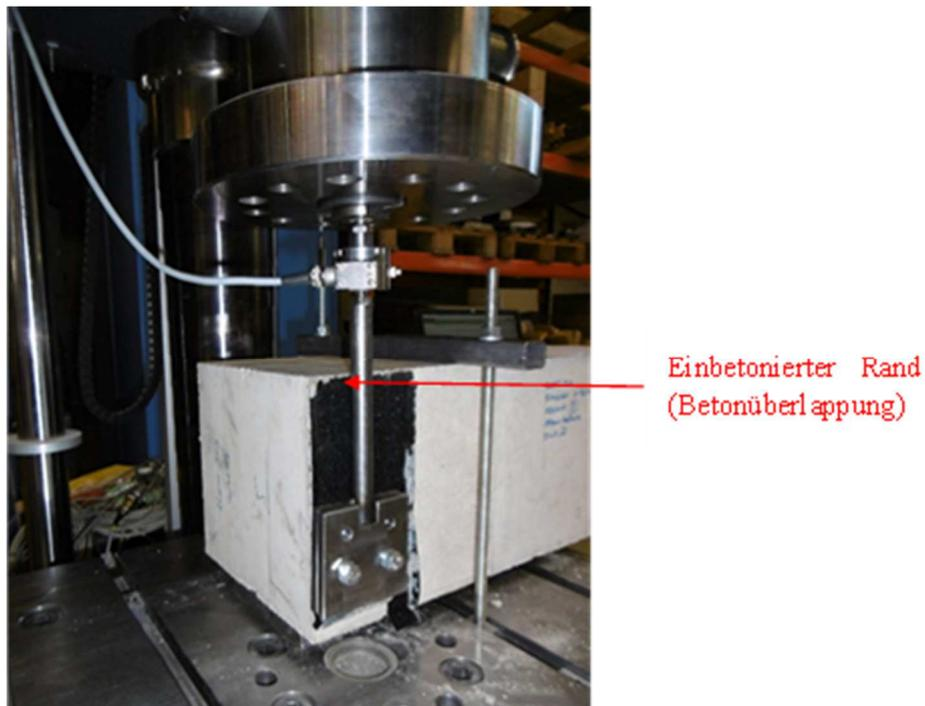
Abbildung 4.56 Flausch mit Betonüberlappung
