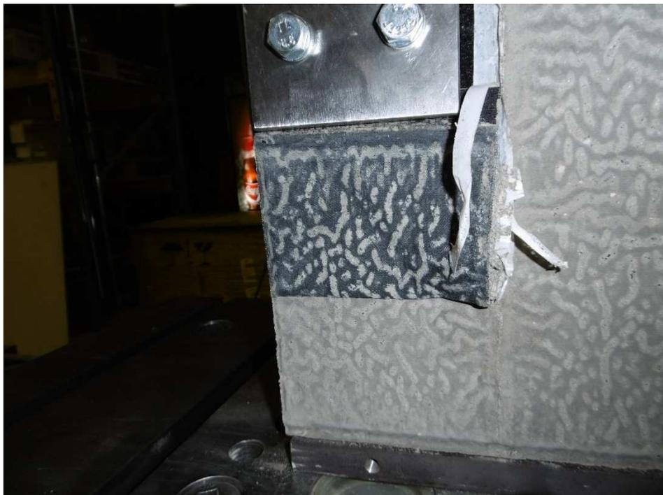
Abbildung 4.47 Ablösung des einlagigen Flausch erfolgt rückstandsfrei
