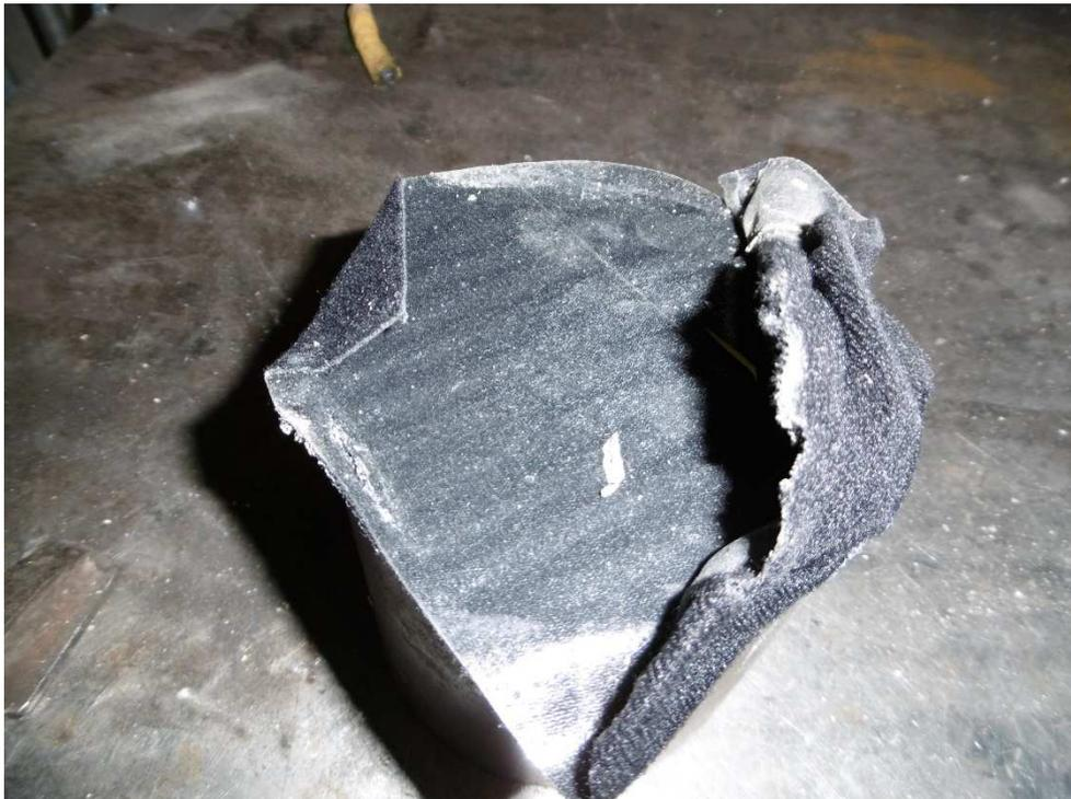
Abbildung 4.37 Flauschmatte vom Beton abgelöst
