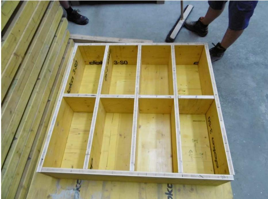
*Abbildung 4.2 Schalung für alle acht Versuchskörper*
