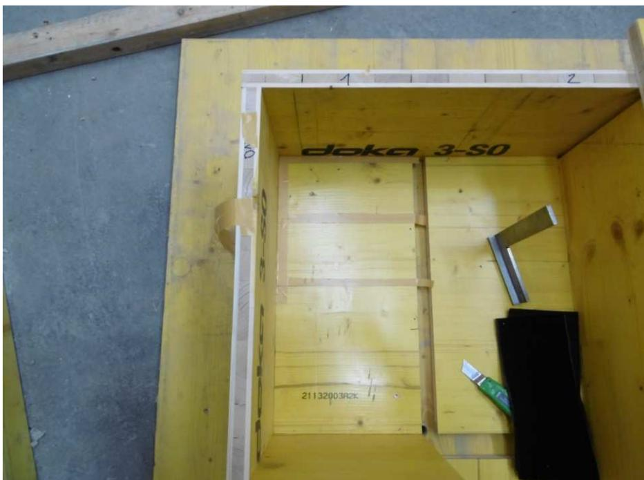
*Abbildung 4.3 Versuchskörper 1, Einkleben der doppelseitigen Klebebänder*
