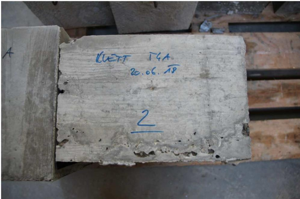
Abbildung 4.12 Versuchskörper 2 - Veloursmatte verklebt mit doppelseitigem Klebeband
