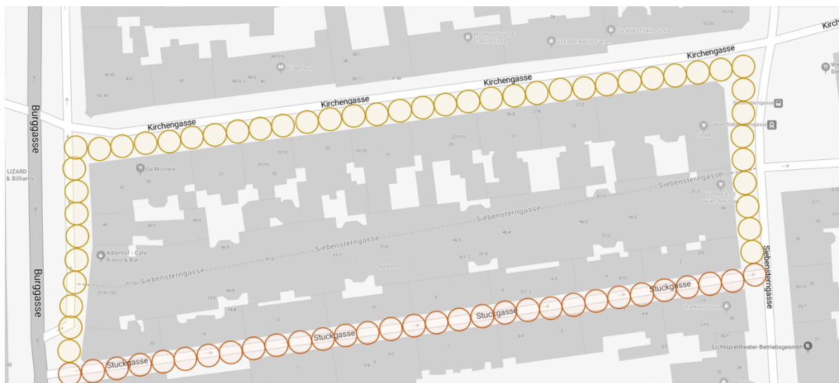
Abbildung 19: Visualisierung der maximal zur Verfügung stehenden öffentlichen Flächen für die Abschätzung des Geothermiepotenzials inkl. Darstellung der maximal möglichen Sondenanzahl bei einem Sondenabstand von 7 m
