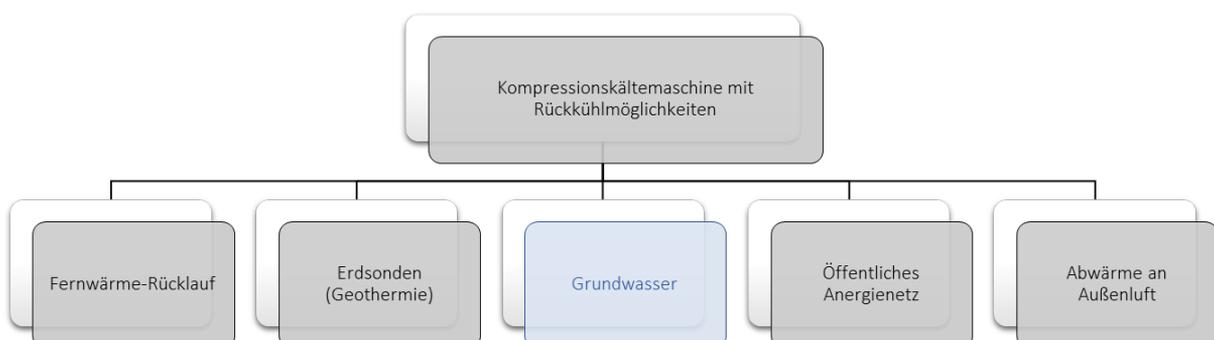
Häufig wird im ersten Schritt die **Nutzung des Erdreichs (Geothermie)** als Wärmesenke angestrebt. Besteht jedoch die Möglichkeit der Grundwassernutzung, ist dies häufig die kostengünstigere Variante.
