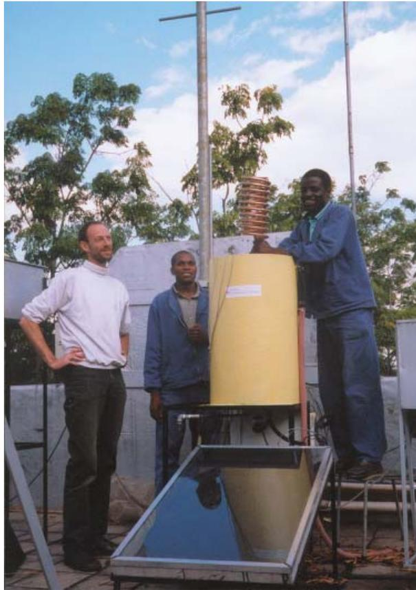
Abbildung 6: Die Versuchs- und Testanlage am Department of Mechanical Engineering der Universität von Zimbabwe in Harare.
