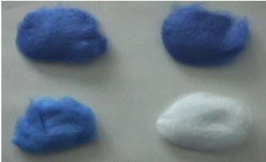
Abbildung 3: Rainbow- und Viskosefaser unter Polyester- und Normalbedingungen gefärbt (Farbstoff: Remazol R)
