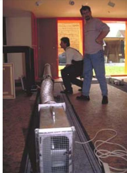
Luftdichtheitsmessung über das Lüftungsgerät
