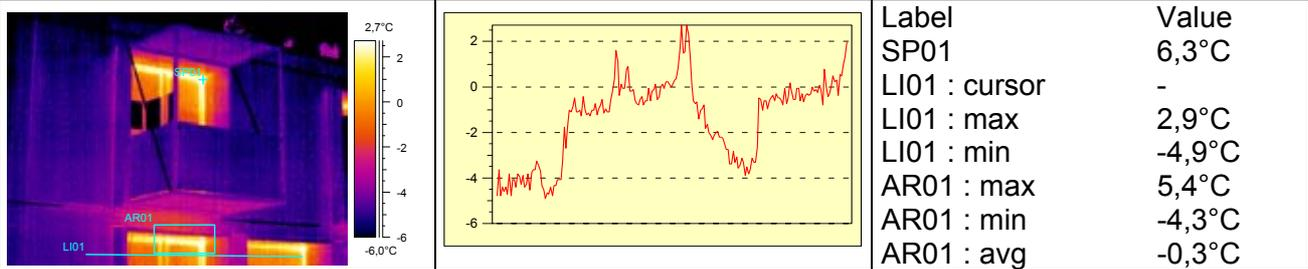
Die Abbildung zeigt einen Teil der Westfassade des Gebäudes. Die im oberen Bereich der Fenster auftretenden hohen Temperaturen sind vermutlich auf nicht gut schließende Fenster zurückzuführen.
